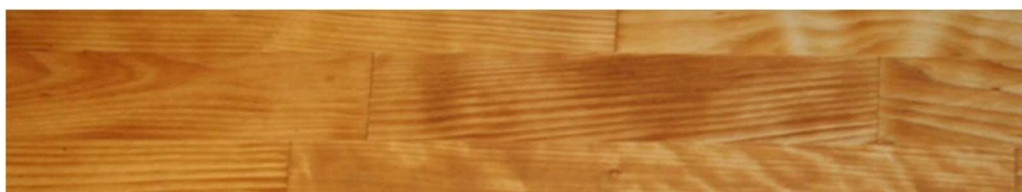
Vzorek z lepených březových dílů, ošetřený olejem.
